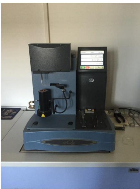
Slika 3.6. TGA Q 500 2910 (TA Instruments), ZPIOKT, FKIT
