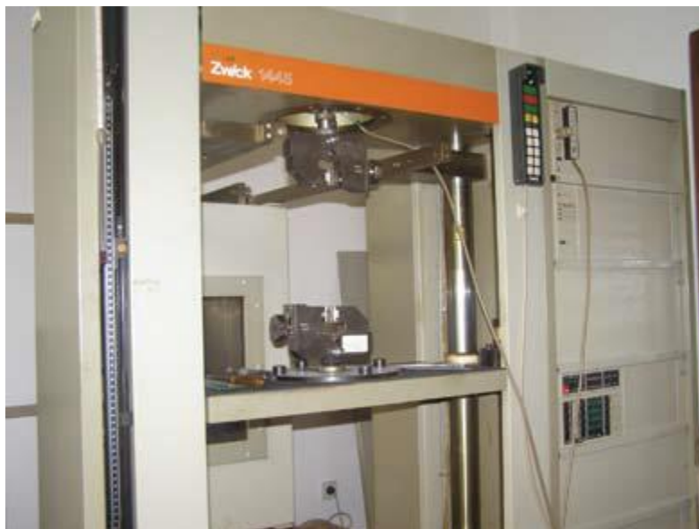
Slika 3.9. Univerzalna mehanička kidalica ZWICK/RÖEL UTM 1445, SVECIPO, FKIT 23
