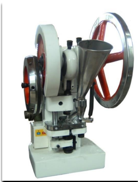
Slika 11. Fotografija uređaja za tabletiranje TDP-5T (Zhejiang Wisely Machinery Co., Ruian, NR Kina)
