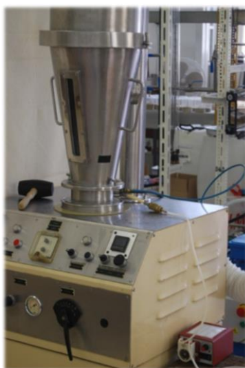
Slika 10. Fotografija granulatora s fluidiziranim slojem Uni-Glatt (Glatt GmbH, Binzen, SR Njemačka)
