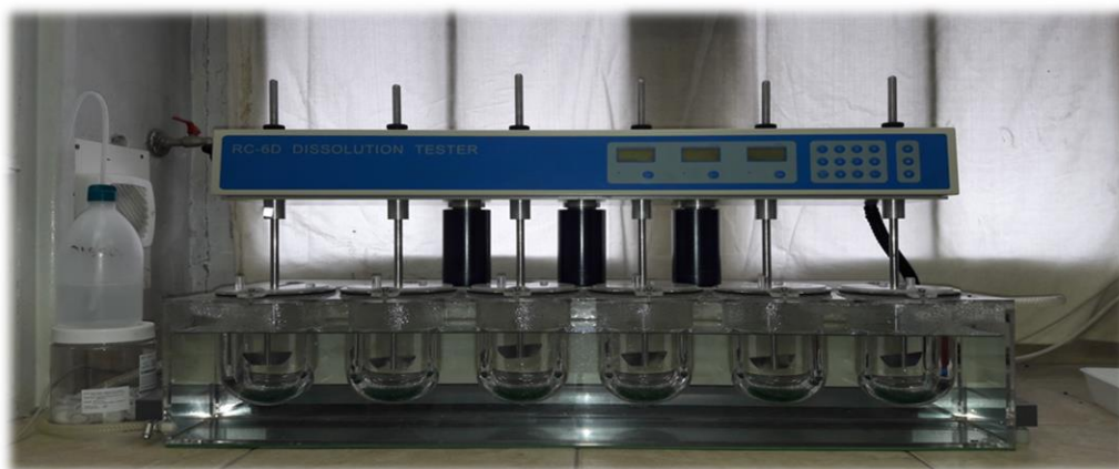
Slika 21. Fotografija uređaja za ispitivanje oslobađanja djelatne tvari RC-6D (Zhengzhou Nanbei Instrument, Henan, NR Kina)
