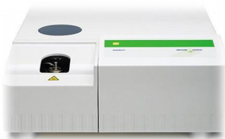
Slika 12. Fotografija diferencijalnog pretražnog kalorimetra Mettler Toledo 822° (Mettler Toledo GmbH, Greifensee, Švicarska)
