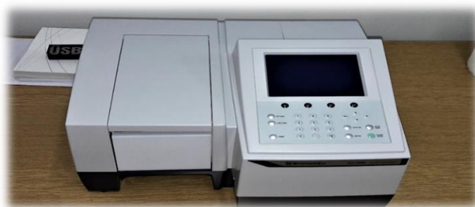
Slika 20. UV/Vis-spektrofotometar Shimadzu UV-1280 (Shimadzu, Kyoto, Japan)
