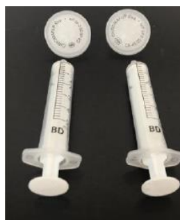
Slika 3.12. Prikaz injekcije s filterima promjera 0,45 µm.
