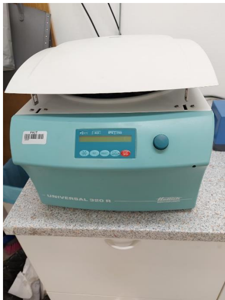
Slika 23. Centrifuga Universal 320R (Hettich Zentrifugen)
