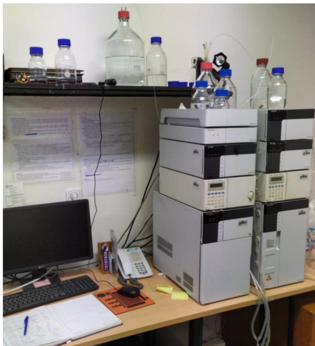
Slika 19. HPLC s UV detektorom, Shimadzu (Japan)
