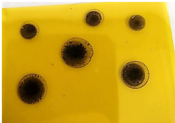
Slika 32. Primjer CRE A-EGSS na poliimidnoj podlozi.
