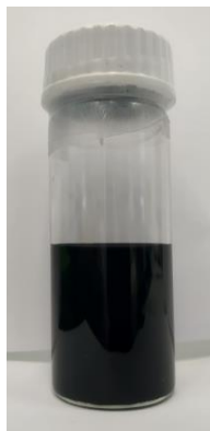
Slika 29. MWCNT–COOH u smjesi MQ vode i etanola sa SOLSPERSE stabilizatorom i sinergistom, početne koncentracije 3 \text{ mg mL}^{-1} , uslikano po završetku homogenizacije.
