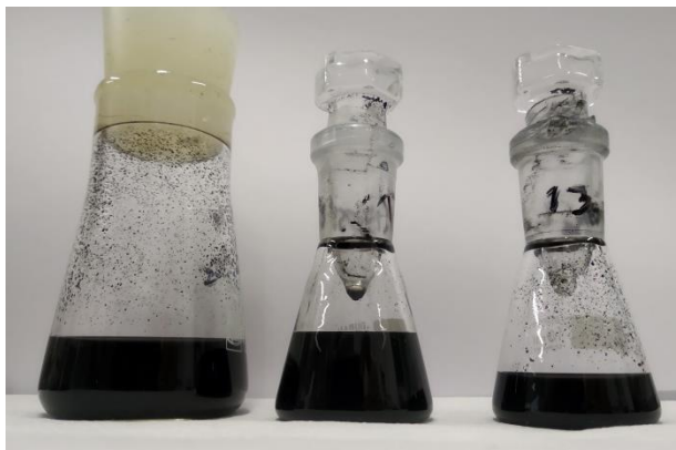
Slika 26. Ispitivanje najboljeg omjera CNT i stabilizatora, početna koncentracija MWCNT je 3 \text{ mg mL}^{-1} , a udio stabilizatora 25, 40 i 75 % u odnosu na masu suhих MWCNT, fotografirano po prestanku homogeniziranja.
