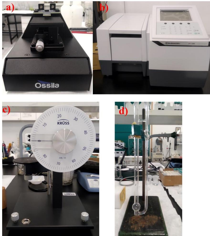
Slika 7. a) *Ossila Four Point Probe* instrument za mjerjenje otpora u četiri točke,
