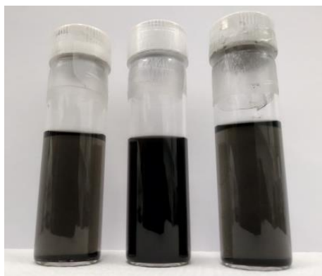
Slika 12. MWCNT u etanolu s 25, 40 i 75 % stabilizatora PVB u odnosu na masu nanocjevčica, početna koncentracija MWCNT u disperzijama je 0,5 mg mL -1 , uslikano 5 dana nakon homogeniziranja.
