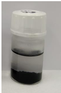
Slika 18. MWCNT u etanolu početne koncentracije 0,5 \text{ mg mL}^{-1} sa stabilizatorom SOLSPERSE koncentracije 0,4 \text{ mg mL}^{-1} fotografirano po vađenju iz ultrazvučne kupelji.
