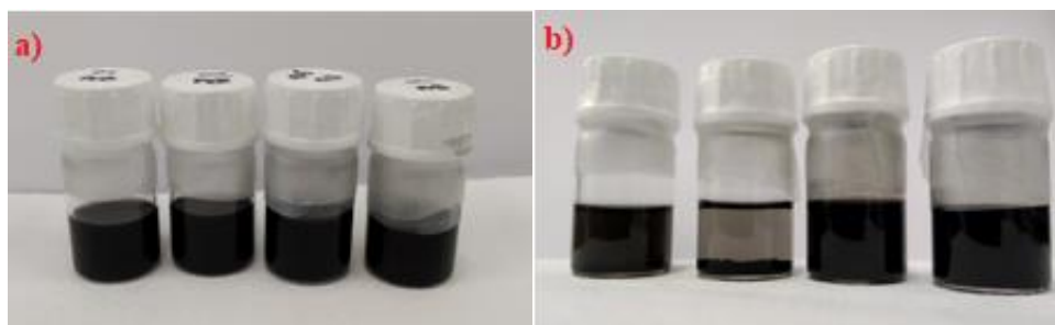
Slika 11. Nemodificirane MWCNT u etanolu, početne koncentracije 0,5, 1, 3 i 10 mg mL -1 sa stabilizatorom PVB, uslikano: a) nakon homogeniziranja, b) pet dana nakon homogeniziranja.
