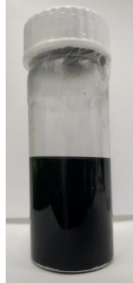
Slika 15. Nemodificirane MWCNT u izopropanolu s PVB-om početne koncentracije 3 \text{ mg mL}^{-1} , uslikano po vađenju iz ultrazvučne kupelji.
