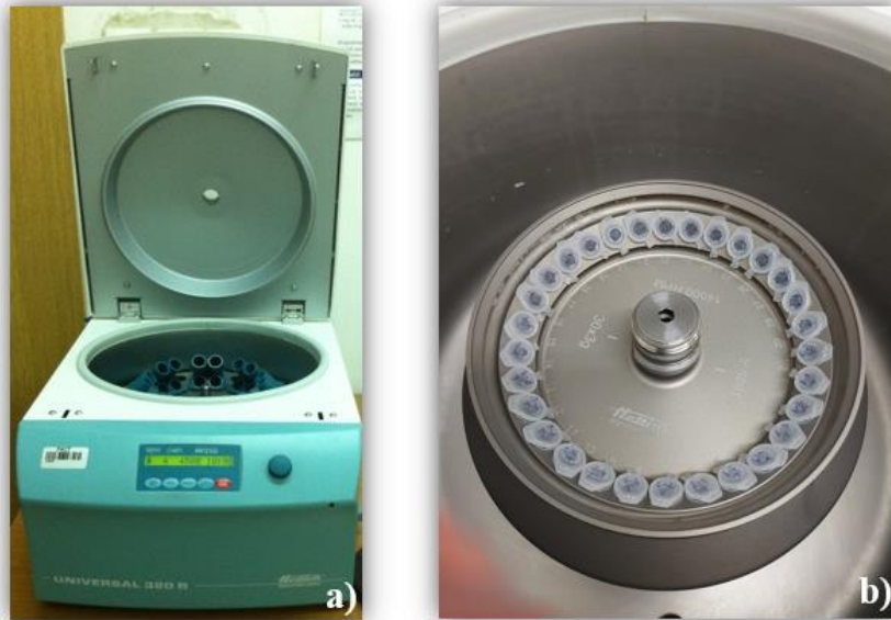
Slika 3.2. a) Centrifuga Hettich Universal 320R i b) Rotor korišten za centrifugiranje reaktora malih volumena
