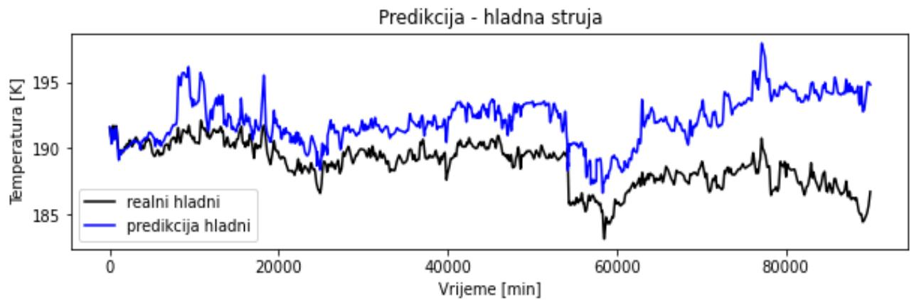
**Slika 31.** Usporedba temperature na izlazu iz izmjenjivača dobivenih modelom i realnih temperatura za hladnu struju kroz period od 90 000 podataka
