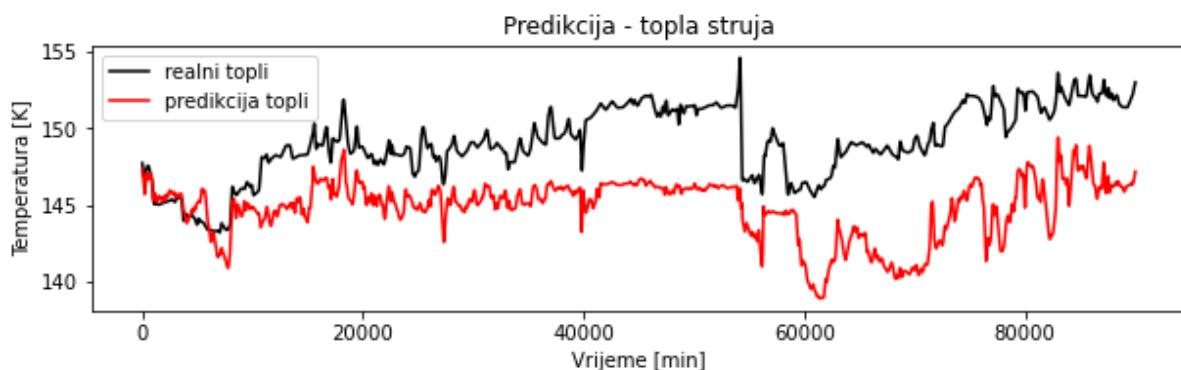
**Slika 32.** Usporedba temperature na izlazu iz izmjenjivača dobivenih modelom i realnih temperatura za toplu struju kroz period od 90 000 podataka
