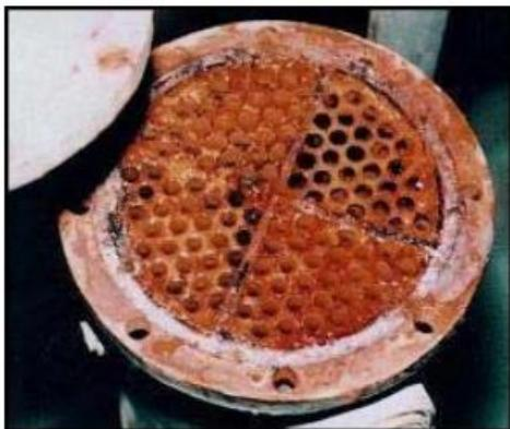
Slika 5. Zaprljani izmjenjivač topline [6]
