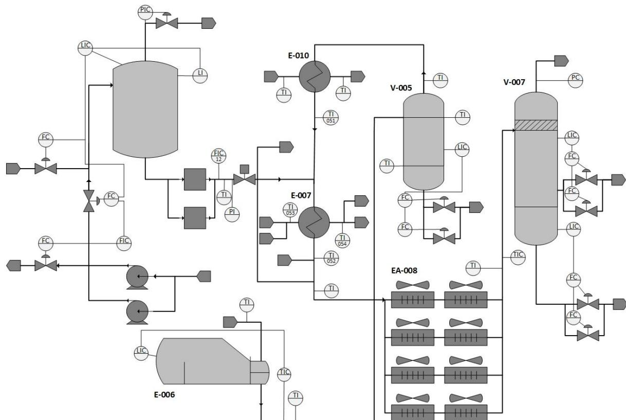
**Slika 23.** Shema procesa hidrokrekinga – dio postrojenja s ispitivanim izmjenjivačem topline
