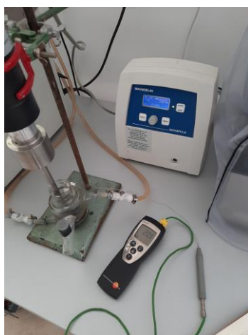
Slika 16. Ultrazvučna sonda, Bandelin sonoplus HD 3200
