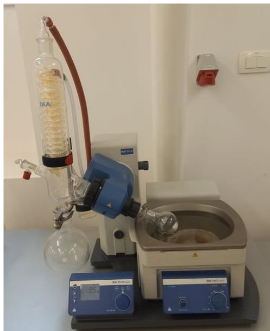
Slika 9. Rotacijski vakum isparivač IKA RV 10 basic korišten za pripremu DES-ova
