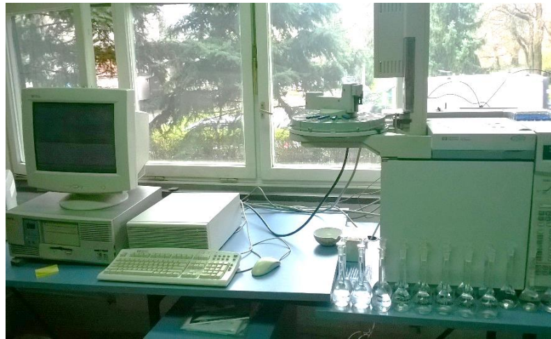
Slika 16. Plinski kromatograf HP Agilent 6890 Series
