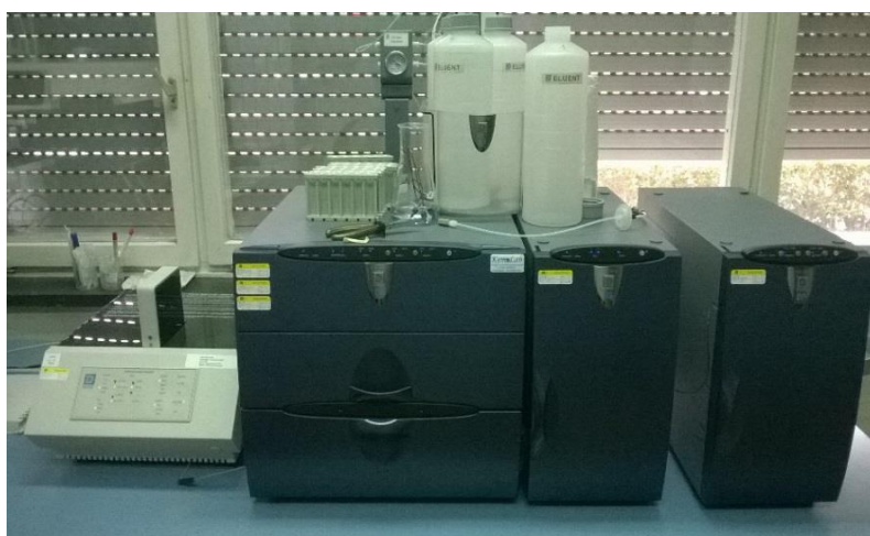
Slika 15. Ionski kromatograf Kemolab Thermo Scientific™ Dionex™ ICS-3000
