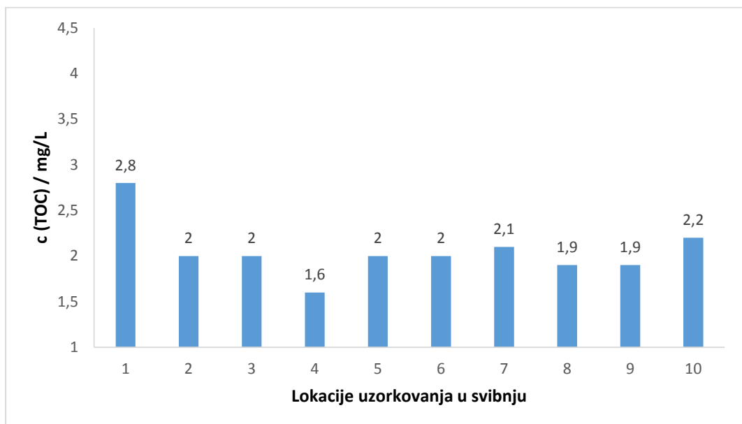
Slika 35. Grafički prikaz ovisnosti koncentracije TOC-a o lokaciji uzorkovanja u svibnju
