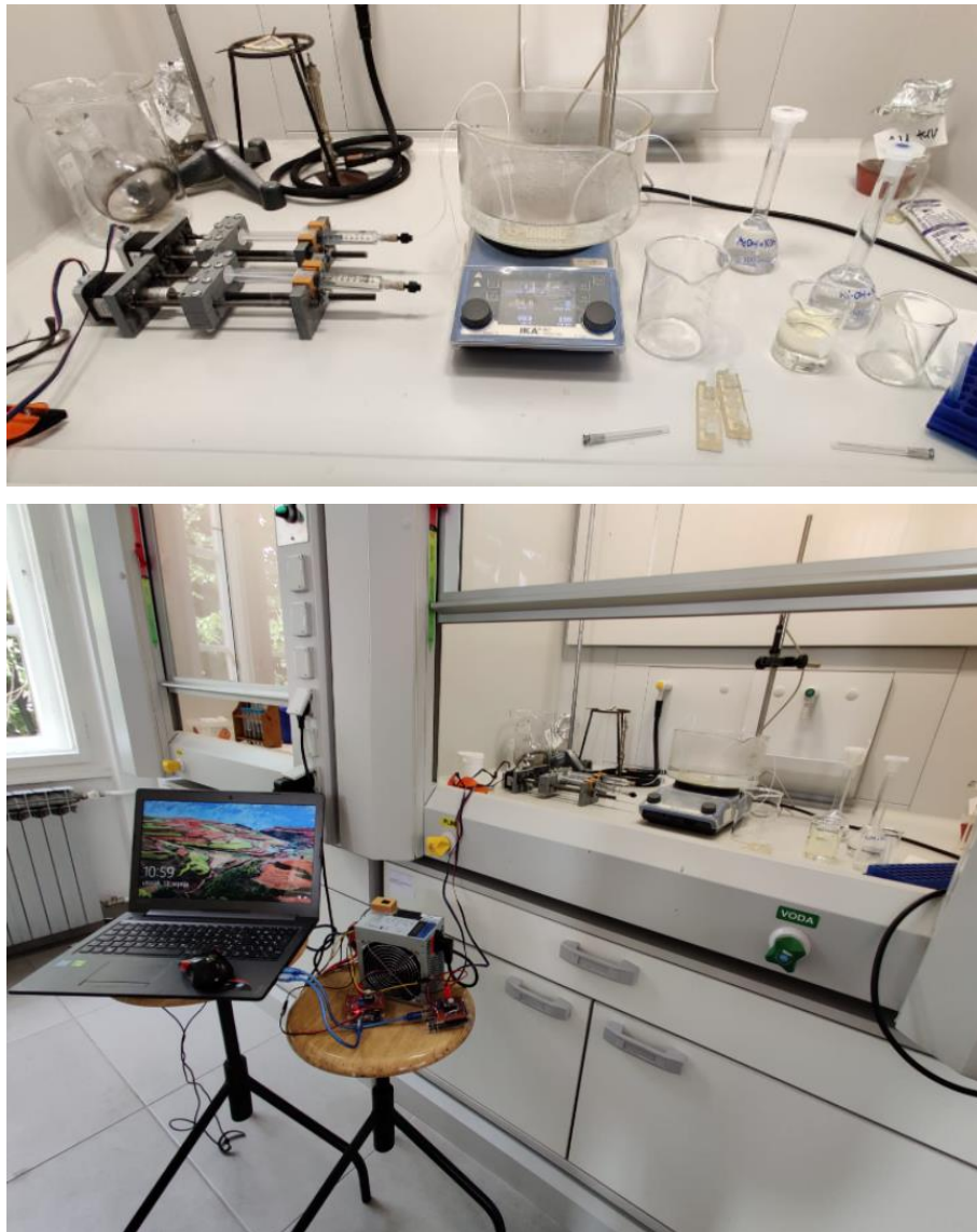
Slika 16. Aparatura za sintezu biodizela
