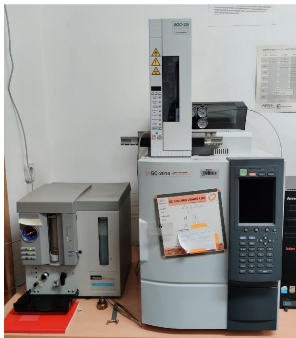
Slika 17. Plinski kromatograf Shimadzu GC-2014 s FID detektorom
