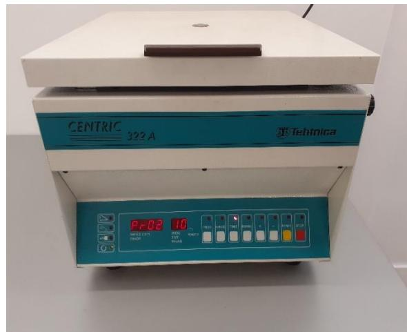
**Slika 17.** *Centrifuga CENTRIC 322 A Tehnica.*
