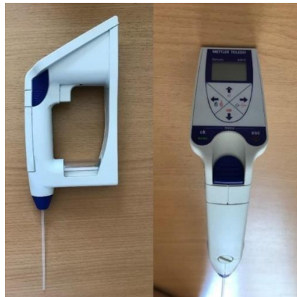
Slika 12. Uređaj za mjerenje gustoće Mettler Toledo Densitometer 30PX .
