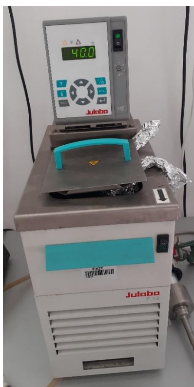
Slika 20. Termostat F12 Julabo .
