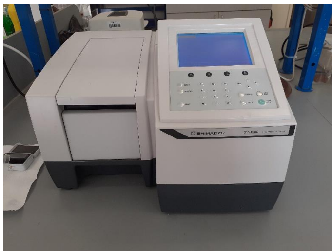
Slika 15. UV/VIS spektrofotometar ( UV-1280 ) SHIMADZU .
