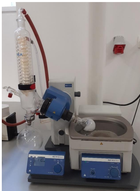
Slika 10. Vakuum isparivač IKA RV 10 basic .
