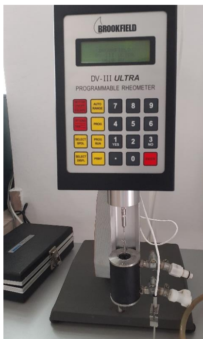
Slika 13. Brookfield DV-111 ULTRA reometar za određivanje viskoznosti.
