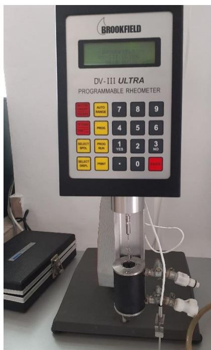
Slika 13. Brookfield DV-111 ULTRA reometar za određivanje viskoznosti.
