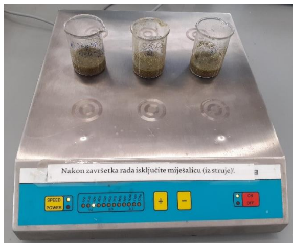
Slika 16. Rotamix 609 MM, Tehnica magnetna miješalica.
