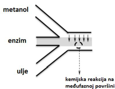
Slika 7. Shematski prikaz mikrorekaktorskog sustava za sintezu biodizela s tri ulaza [28]
