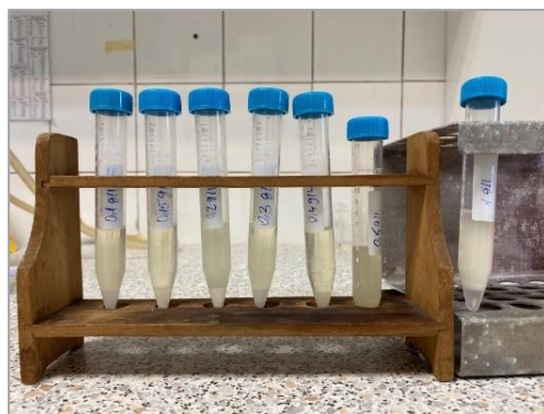
Slika 23. Ispitivanje utjecaja koncentracije emulgatora SDS-a na stabilnost emulzija – izgled emulzija 24 sata nakon priprave
