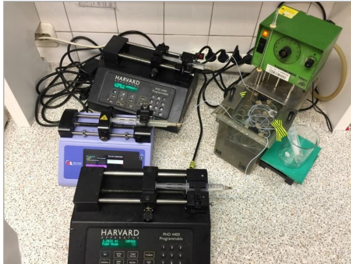
Slika 13. Aparatura za provedbu sinteze biodizela u mikoreaktoru s tri ulaza opremljenim sa spojnicom +-oblika
