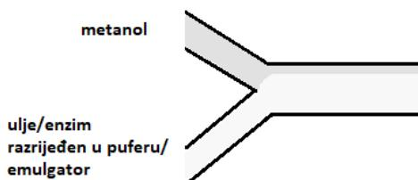
Slika 6. Shematski prikaz mikroreaktorskog sustava za proizvodnju biodizela s dva ulaza
