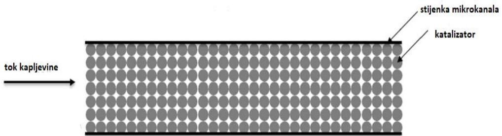
Slika 4. Mikrostrukturirani reaktor s pravilnom raspodjelom čestica katalizatora [8]
