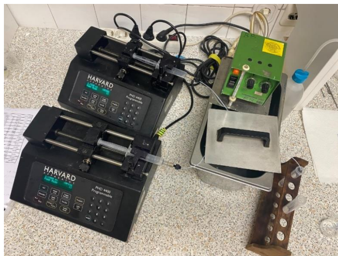
Slika 14. Aparatura za provedbu sinteze biodizela u mikoreaktoru s dva ulaza opremljenim sa spojnicom T-oblika
