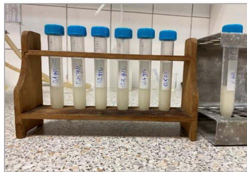
Slika 22. Ispitivanje utjecaja koncentracije emulgatora SDS-a na stabilnost emulzija – izgled emulzija neposredno nakon pripreme
