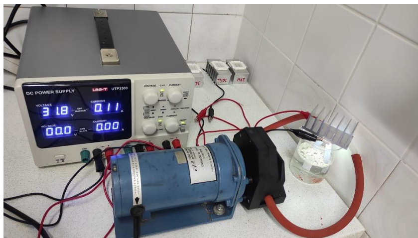
Slika 11. Eksperimentalni sustav korišten za proces fotokatalize
