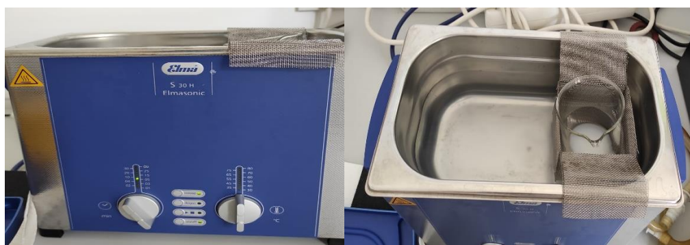
Slika 7. Uređaj korišten za sonikaciju i prikaz sonikacije uzorka
