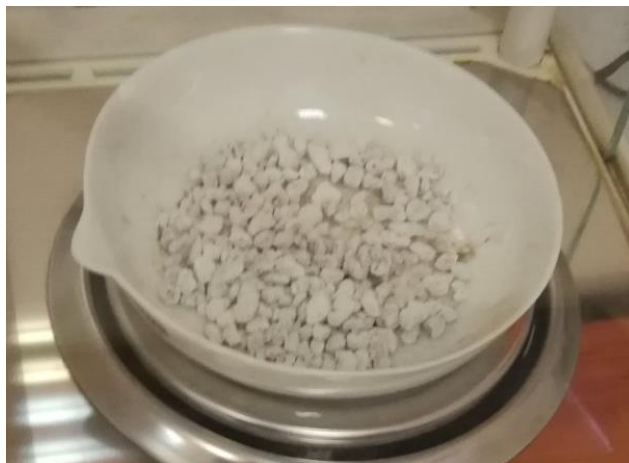
Slika 10. Katalizator na bazi perlita dobiven sol-gel metodom (1)
