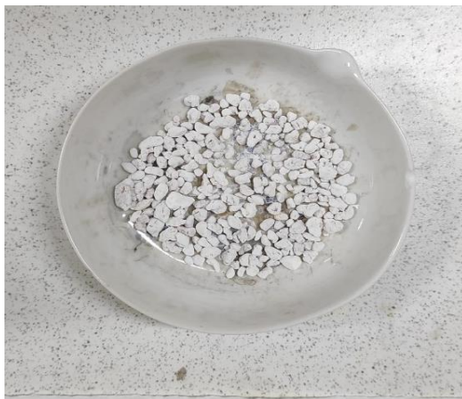
Slika 9. Katalizator na bazi perlita dobiven metodom impregnacije uz dodatak vodenog stakla (0)
