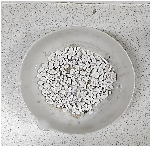
Slika 8. Katalizator na bazi perlita dobiven metodom impregnacije (-1)
