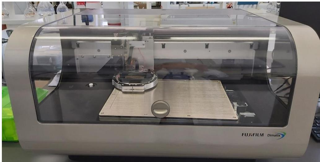
**Slika 3.12.** Pisač FUJIFILM Dimatix Materials Printer DMP-2850
