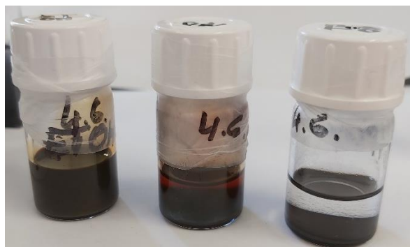
Slika 4.6. Izgled suspenzija uzorka I 1 dispergiranog u EtOH, IzoOH i TpOH sa slike 4.5. nakon 48 sati stajanja
