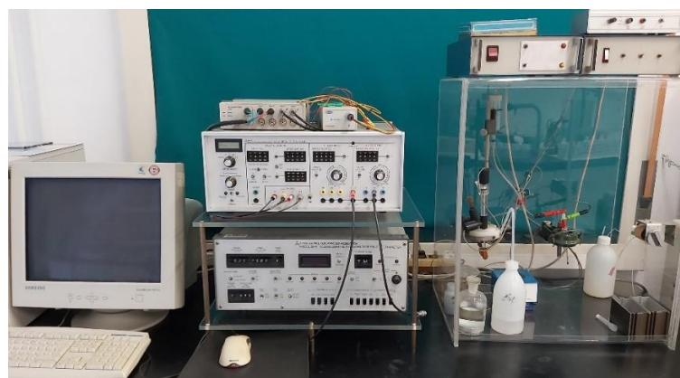
**Slika 3.4.** Aparatura za cikličku voltametriju
