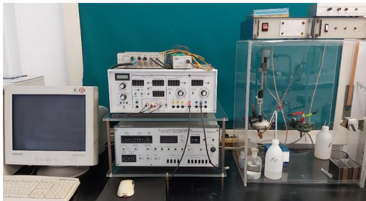
Slika 3.4. Aparatura za cikličku voltametriju
