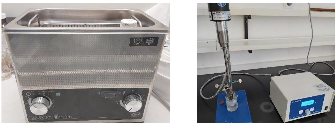
Slika 3.10. a) Ultrazvučna kupelj, b) ultrazvučna sonda
