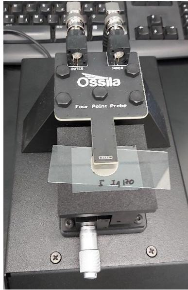
**Slika 3.11.** Sonda za mjerenje otpora u četiri točke
