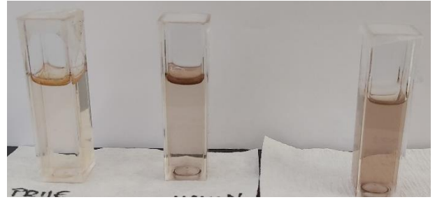
Slika 4.28. a) Kivete s tintom I 1 IzoOH/H 2 O razrijeđenom u omjeru 500:1 nakon snimanja spektra, b) kivete s tintom razrijeđenom u omjeru 500:1 nakon 4 dana stajanja
