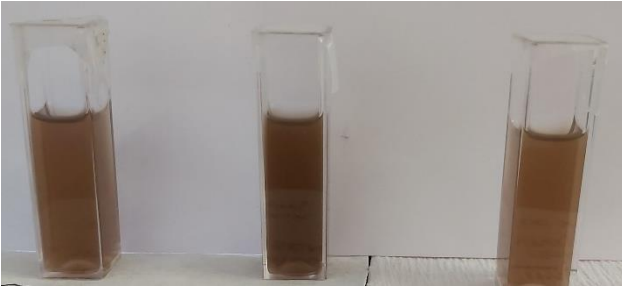
Slika 4.28. a) Kivete s tintom I 1 IzoOH/H 2 O razrijeđenom u omjeru 500:1 nakon snimanja spektra, b) kivete s tintom razrijeđenom u omjeru 500:1 nakon 4 dana stajanja
