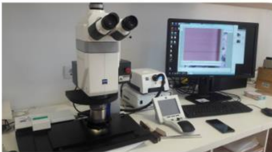
Slika 11. Optički mikroskop Axio Zoom V16 tvrtke Zeiss
