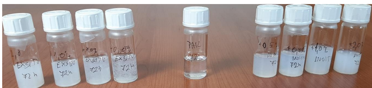
Slika 34. Neotopljeni PAK i PAK/TiO 2 ex situ i in situ filmovi u THF-u nakon 72 sata UV zračenja
