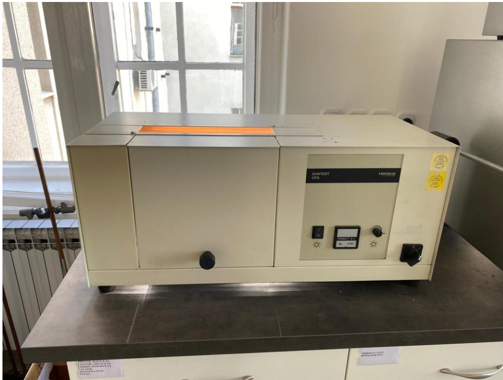
Slika 10. UV komora SUNTEST CPS
