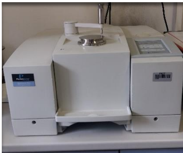
Slika 17. Uređaj za ATR-FTIR analizu, Perkin Elmer, Spectrum One
