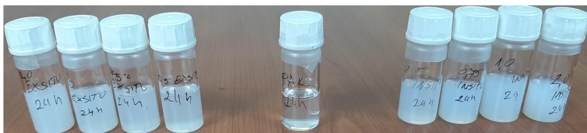
Slika 33. Otopljeni PAK i PAK/TiO 2 ex situ i in situ filmovi u THF-u nakon 24 sata UV zračenja
