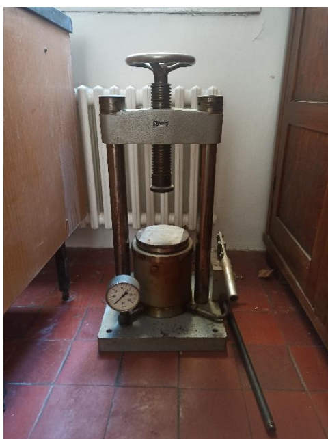
Slika 4.20. Fotografija uređaja za kompaktiranje Paul Weber Stgt. – Uhlbach.
