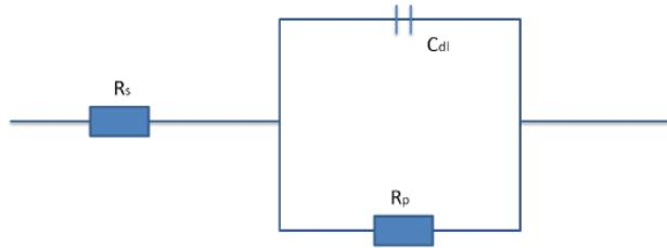
**Slika 3.7.** Shematski prikaz Randles-ovog ekvivalentnog strujnog kruga za jednostavnu elektrokemijsku ćeliju.<sup>31</sup>
