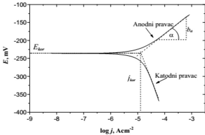
**Slika 3.4.** Određivanje korozijskih parametara metodom Tafelove ekstrapolacije.<sup>1</sup>
