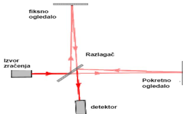
Slika 3.11. Princip rada spektrometra.<sup>35</sup>
