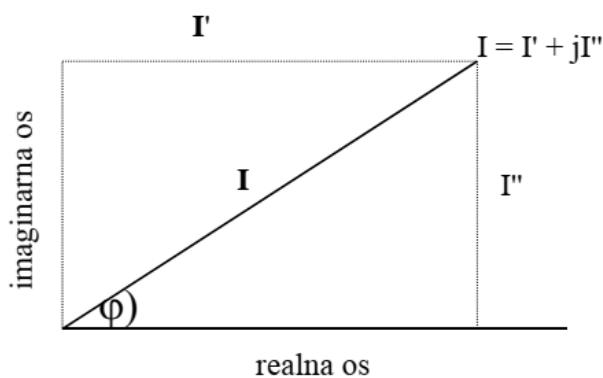
*Slika 3.6.* Prikaz strujnog vektora opisan realnom i imaginarnom komponentom.<sup>28</sup>
