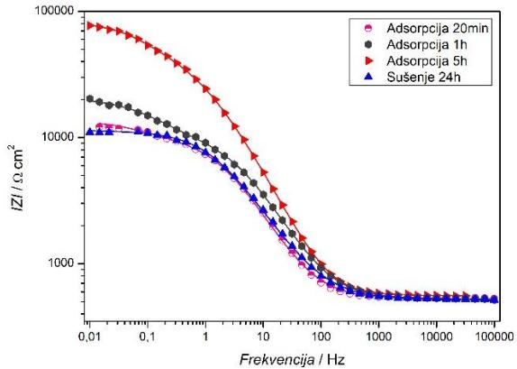
**Slika 4.4.** Grafički prikaz usklađenih EIS podataka prilikom ispitivanja utjecaja trajanja procesa adsorpcije: a) Nyquistov dijagram, b) i c) Bodeovi dijagrami modeliranih podataka.
