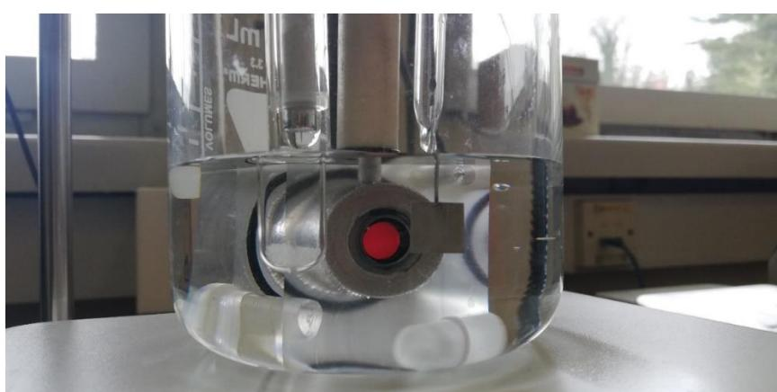
*Slika 3.2.* Korišteni troelektrodni sustav.
