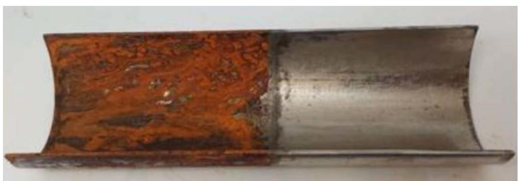
*Slika 2.2. Prikaz iskorodiranog dijela (lijevo) bez nanesene zaštitne prevlake i dijela s nanesenom prevlakom (desno).<sup>37</sup>*
