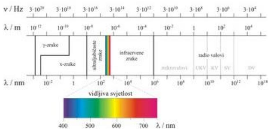
Slika 2.4. Prikaz elektromagnetskog spektra.<sup>42</sup>
