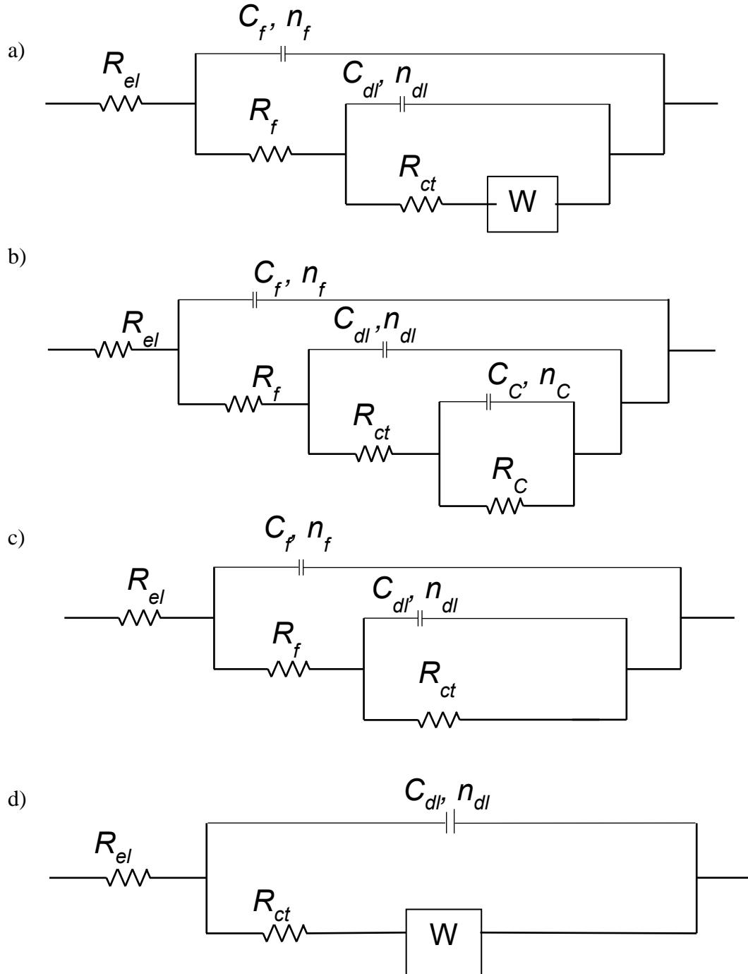
**Slika 4.2.** Prikaz strujnih krugova korištenih za modeliranje eksperimentalnih podataka: a) 2RCW, b) 3RC, c) 2RC, d) 1RCW.
