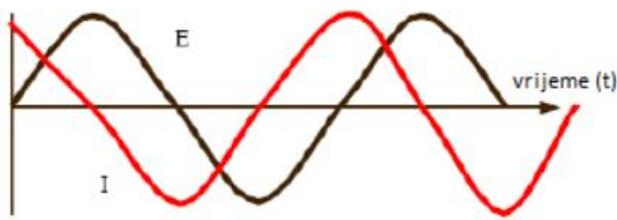
*Slika 3.5.* AC val za primjenjeni potencijal ( $E$ ) i rezultirajuću struju ( $I$ ).<sup>30</sup>
