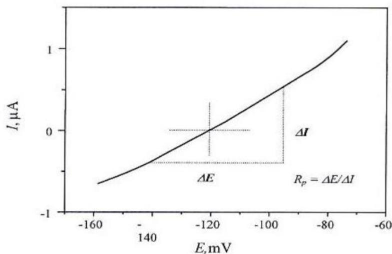
Slika 3.3. Grafički prikaz određivanja polarizacijskog otpora prema Mansfeldu.<sup>1</sup>
