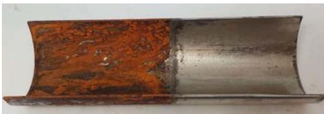
Slika 2.2. Prikaz iskorodiranog dijela (lijevo) bez nanosene zaštitne prevlake i dijela s nanesenom prevlakom (desno). 37
