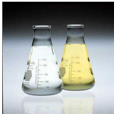
Slika 11. Prikaz Fischer-Tropsch dizela (lijevo) i mineralnog dizela(desno). 38
