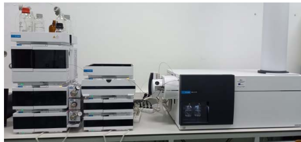
Slika 19. Spektrometar masa visoke razlučivosti
