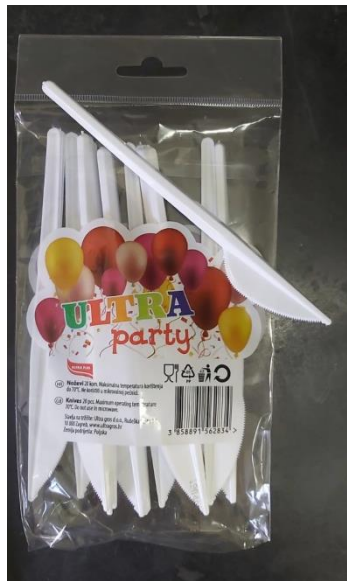
Slika 6. Plastični pribor od PP-a koji se koristio za dobivanje MP-a.
