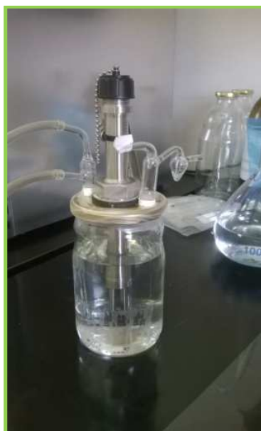
Slika 3.5. Elektrokemijski monitoring LPR metodom.
