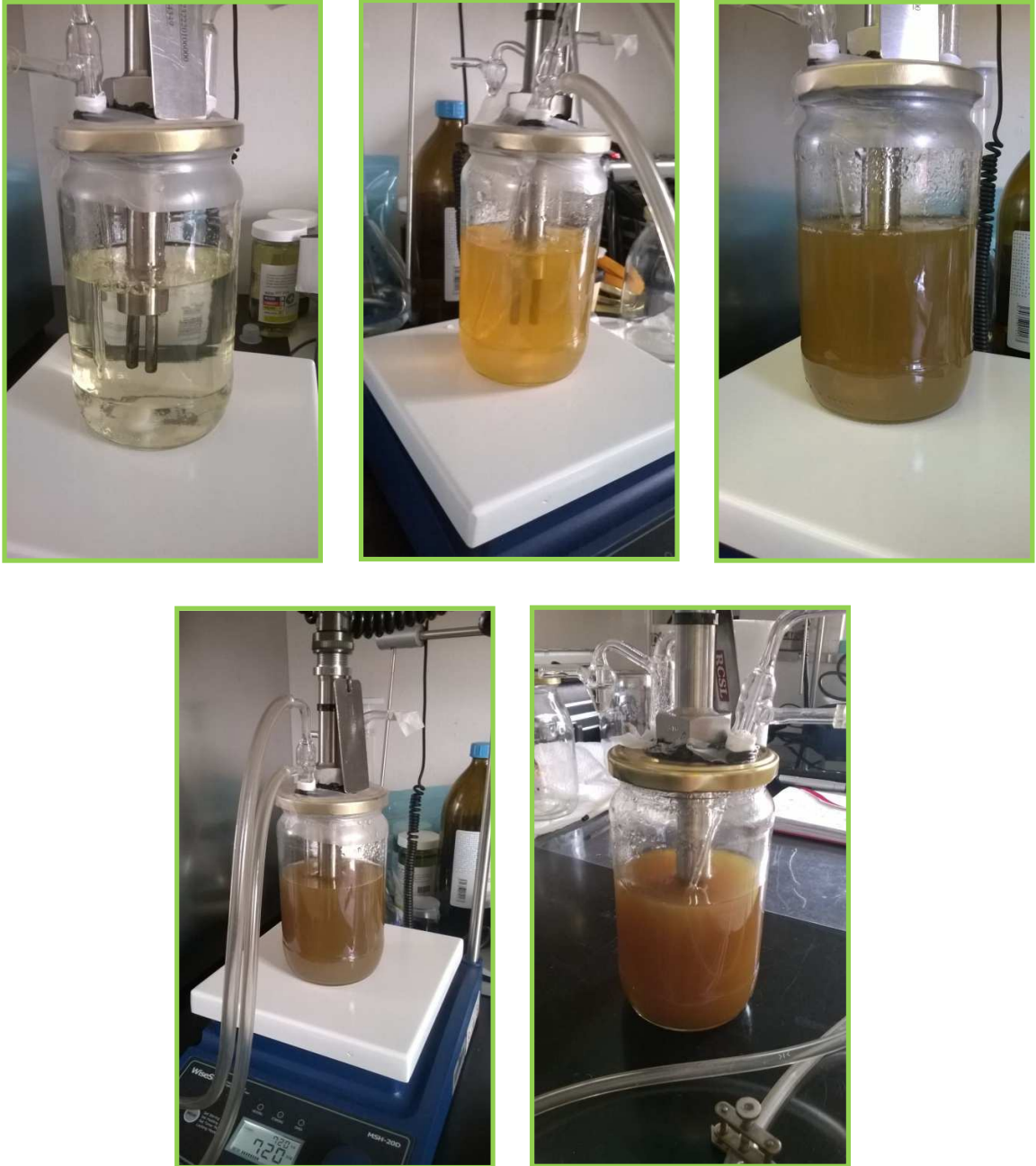
Slika 4.5. Tijek mjerenja po danima za sustav bez dodatka inhibitora.
