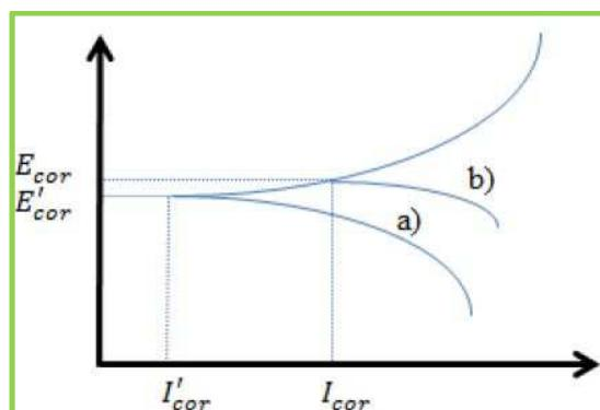
*Slika 2.5. Potenciostatski polarizacijski dijagram metala u otopini
