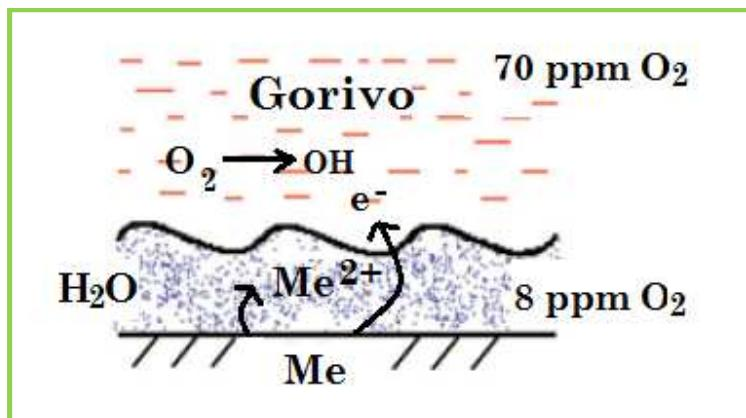
Slika 2.2. Mehanizam korozije.
