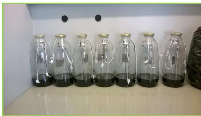
*Slika 3.3. Uzorci izloženi koroziskom djelovanju tijekom 90 dana na sobnoj temperaturi.*
