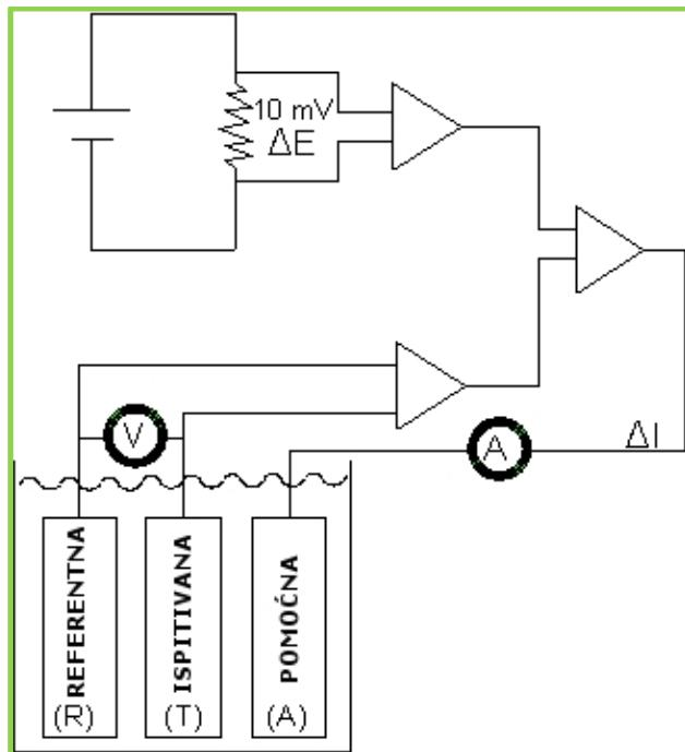
Slika 2.11. Prikaz troelektrodnog sustava.<sup>20</sup>
