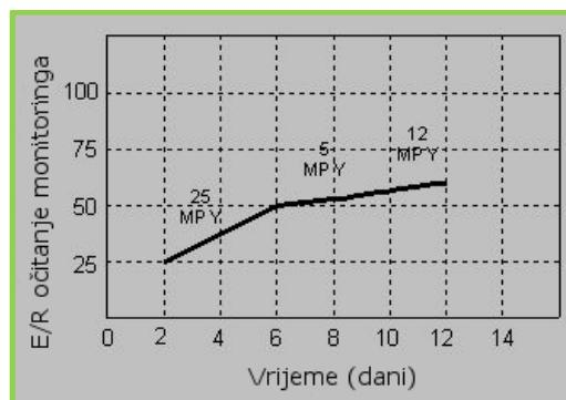
Slika 2.8. Prikaz korozijskog monitoringa ER tehnikom.<sup>20</sup>
