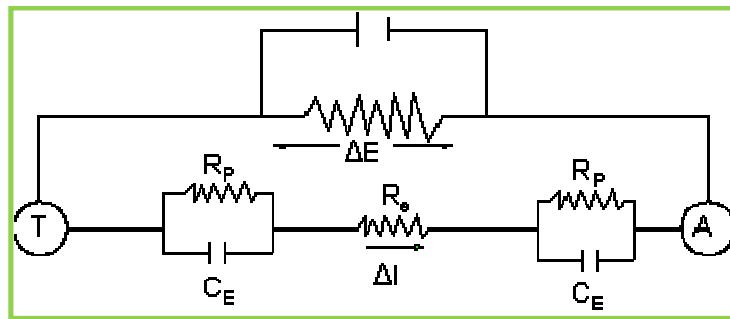
Slika 2.10. Mjerenje polarizacijskog otpora.<sup>20</sup>
