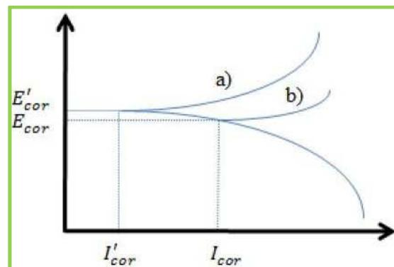
*Slika 2.4. Potenciostatski polarizacijski dijagram u otopini
