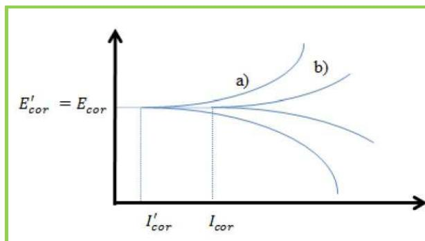
*Slika 2.6. Potenciostatski polarizacijski dijagram metala u otopini
