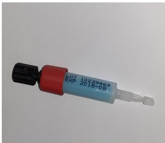
Slika 9. Kromatografska kolona HisTrap™ excel
