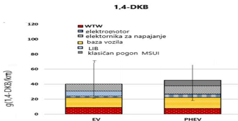
*Slika 18.* Usporedba toksičnog potencijala za EV i PHEV [27]
