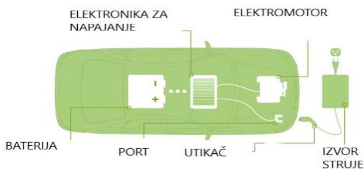
*Slika 10.* Osnovni dijelovi električnog vozila [12]
