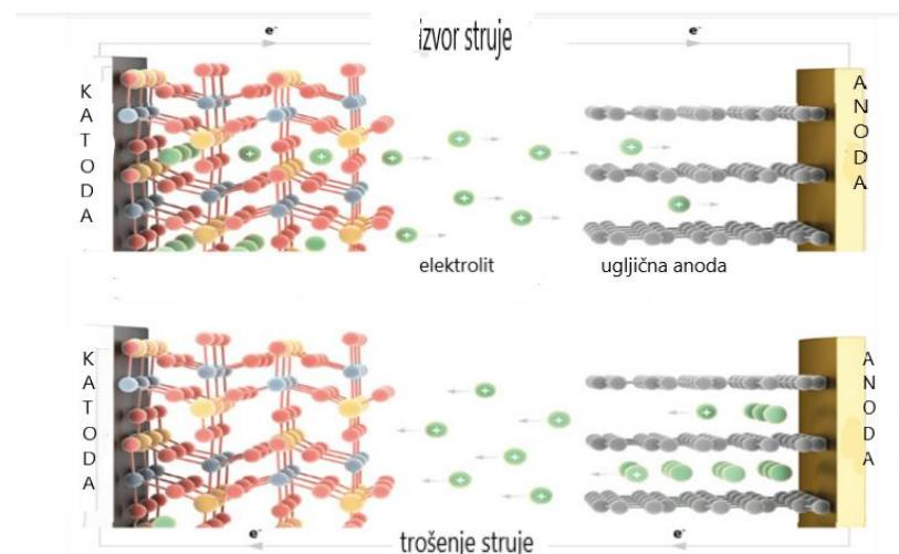
**Slika 11.** Princip rada litij - ionske baterije - punjenje i pražnjenje
