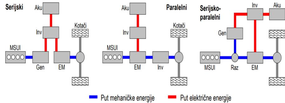
**Slika 13.** Sheme tri vrste hibridnih pogona obzirom na vezu između mehaničkog i električnog dijela vozila [21]
