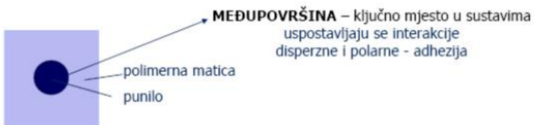
Slika 3. Prikaz međupovršine matrica - punilo
