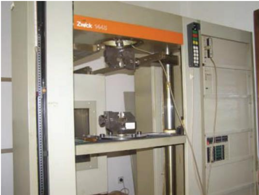
Slika 34. Univerzalna mehanička kidalica ZWICK/RÖEL UTM 1445
