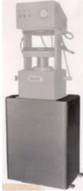
Slika 33. Hidraulička Dake preša 32
