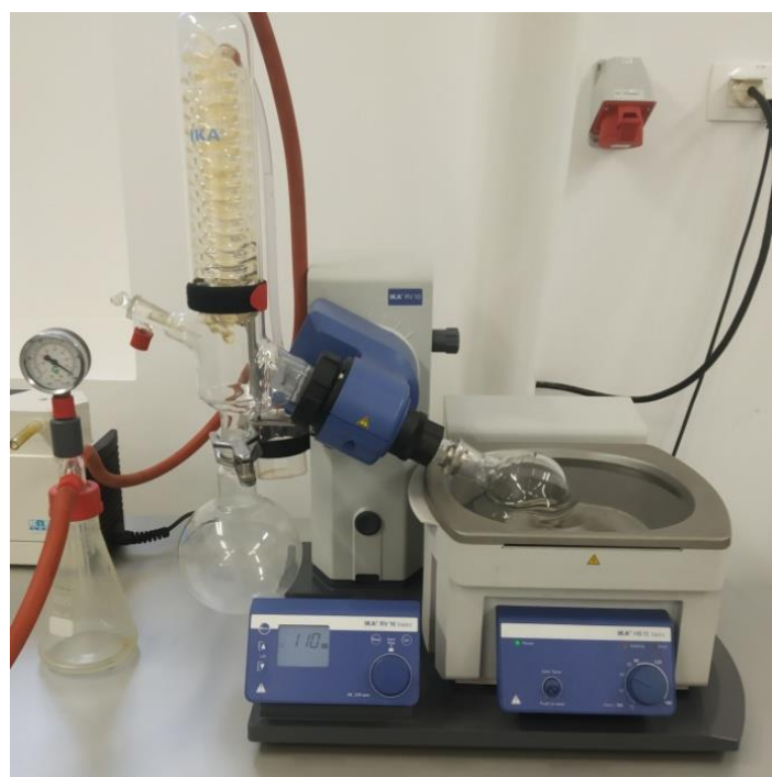
Slika 5. Rotacijski vakuum isparivač IKA RV 10 basic .
