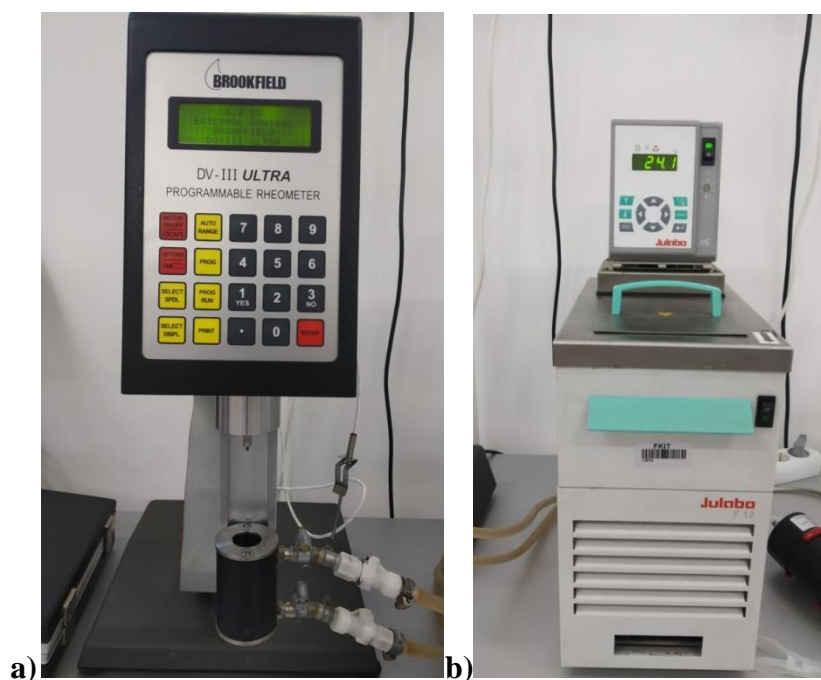
Slika 7. a) Reometar Brookfield DV-111 ULTRA , b) Termostat Julabo F12
