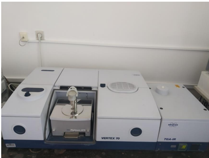
Slika 10. FT-IR spektrofotometar Vertex 70 , Bruker.
