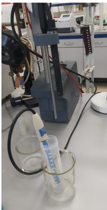
Slika 6. pH elektroda Blue Line (naprijed) i WTW InoLab pH/Cond 740 (iza).
