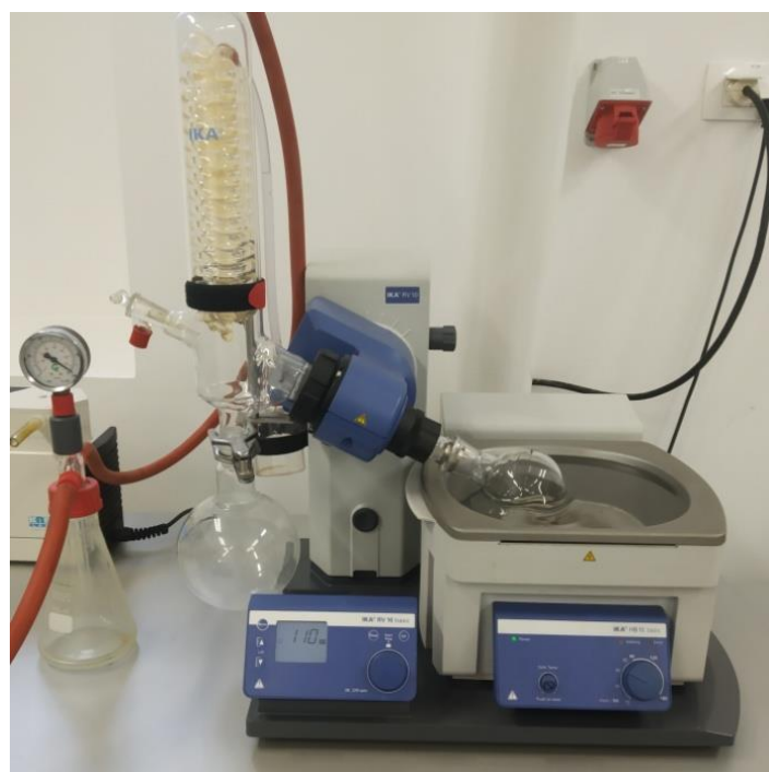
Slika 5. Rotacijski vakuum isparivač IKA RV 10 basic.
