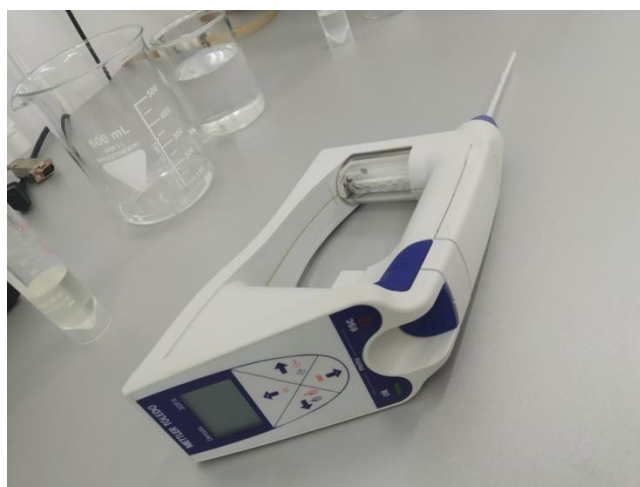
Slika 8. Mettler toledo densitometer 30PX .
