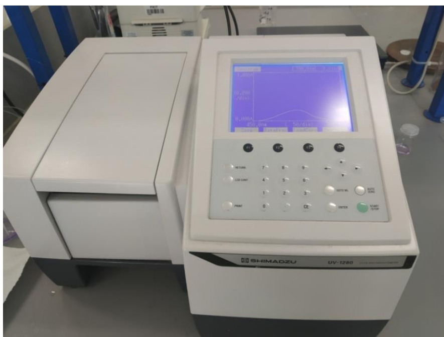
Slika 9. UV/VIS spektrofotometar UV-1280, Shimadzu .
