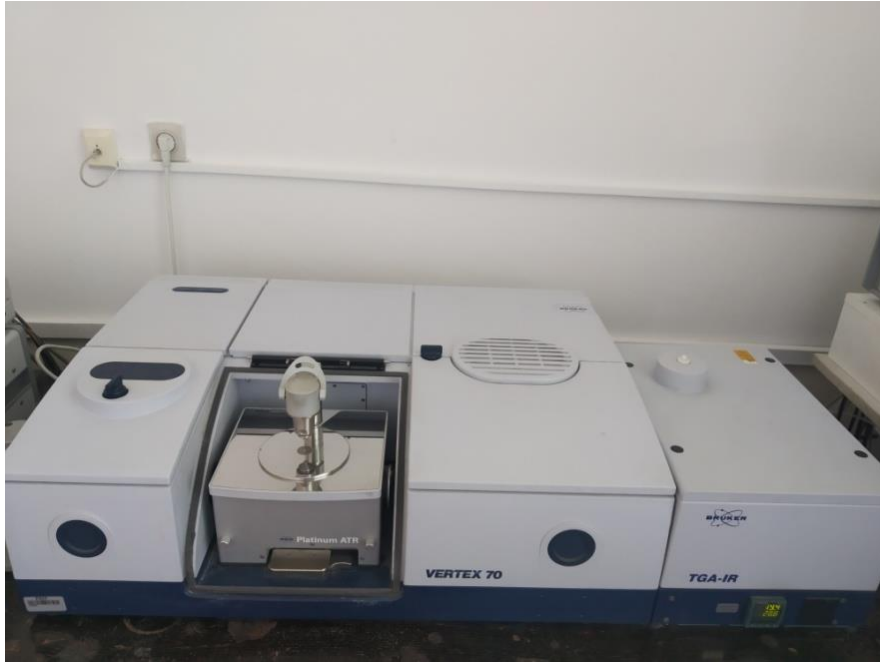
Slika 10. FT-IR spektrofotometar Vertex 70 , Bruker.
