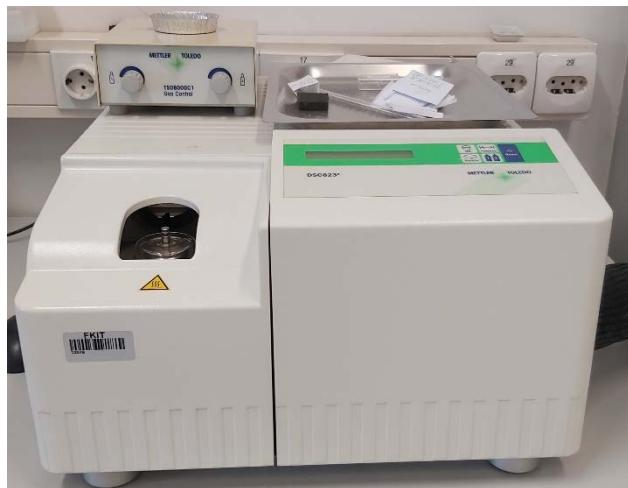
Slika 19. Uređaj Mettler Toledo DSC 823.
