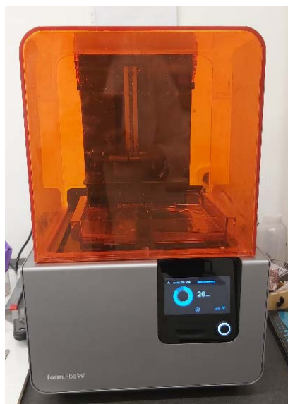
Slika 17. 3D–pisač Form 2 proizvođača Formlabs.
