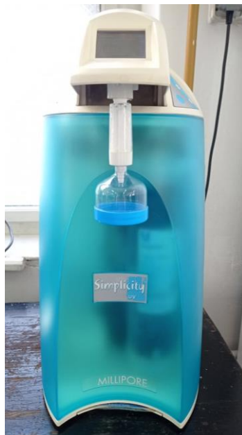
Slika 23. Uređaj za proizvodnju MilliQ vode, Millipore Simplicity UV
