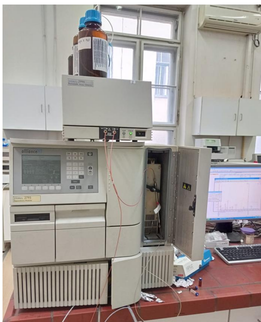
Slika 24. Uređaj Waters 2795 Alliance HPLC systems s 2996 PDA detektorom
