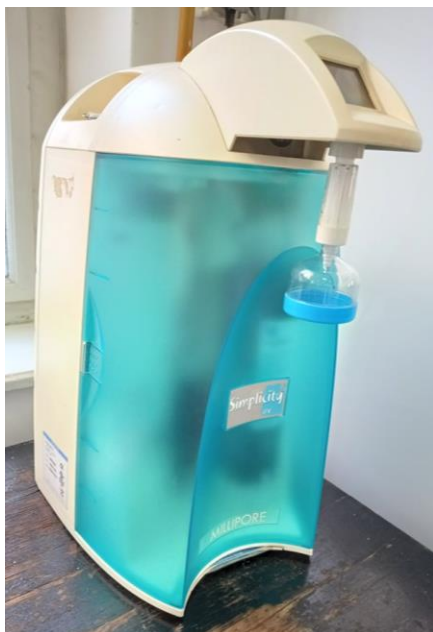
Slika 23. Uređaj za proizvodnju MilliQ vode, Millipore Simplicity UV
