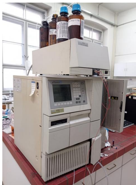
Slika 24. Uređaj Waters 2795 Alliance HPLC systems s 2996 PDA detektorom
