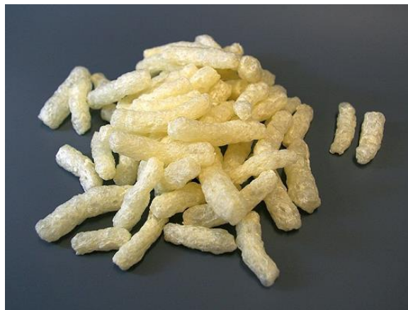
Slika 10. Materijal za pakiranje od termoplastičnog škroba [36]
