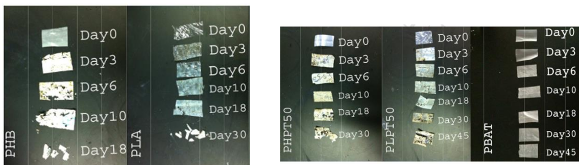
Slika 30. Uzorci u različitom vremenu kompostiranja; čisti PLA i PHB, 50/50 mješavinama PLA / PBAT (PLPT50) i 50/50 mješavina PHB / PBAT / (PHPB50) [11]
