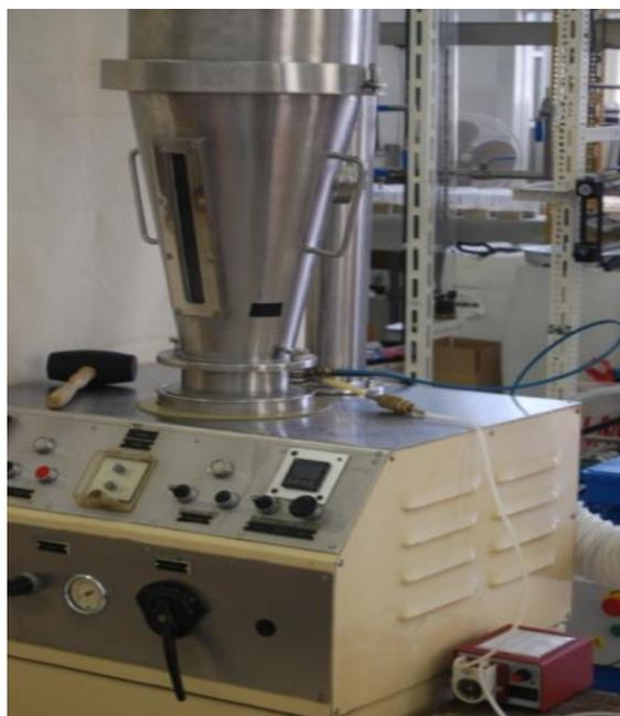
**Slika 10.** *Fotografija granulatora s fluidiziranim slojem Uni-Glatt (Glatt GmbH, Binzen, SR Njemačka)*
