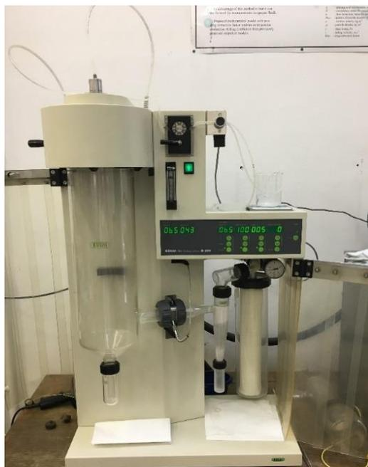
**Slika 12. Laboratorijski sušionik s raspršivanjem (BÜCHI Mini Spray-Dryer B-290)**
