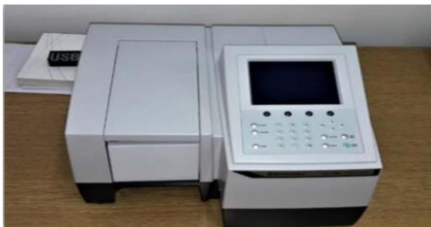
**Slika 15.** Spektrofotometar UV-1280
