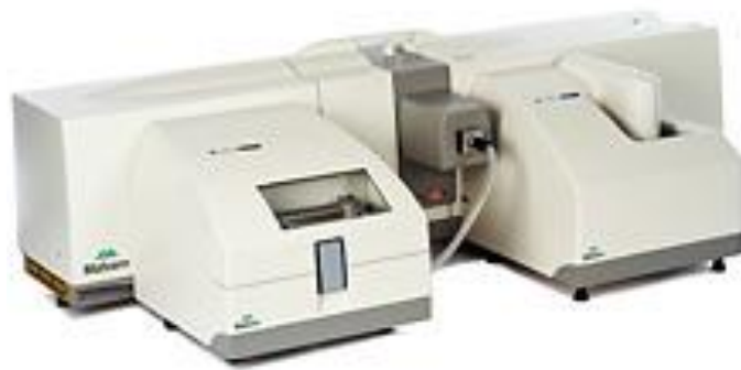
Slika 13. Fotografija uređaja za određivanje raspodjele veličina čestica metodom laserske difrakcije MASTERSIZER 2000 22 (Malvern Instruments Limited, Malvern, Worcestershire, Ujedinjeno Kraljevstvo)
