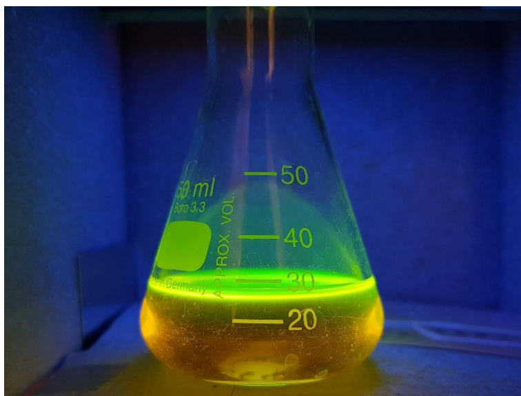
Slika 4. Otopina BODIPY spoja u \text{CH}_2\text{Cl}_2 osvijetljena UV-svjetlom \lambda = 366 \text{ nm}
