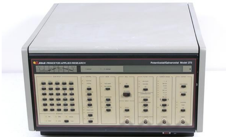
Slika 3.4 Potenciostat/galvanostat EG&G Princeton Applied Research model 273 korišten za ispitivanje komercijalnog superkondenzatora prema zadanoj normi HRN EN 62576
