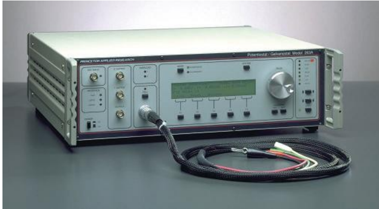
Slika 3.5 Potenciostat/galvanostat EG&G Princeton Applied Research model 263A korišten za ispitivanje komercijalnog superkondenzatora metodom elektrokemijske impedancijske spektroskopije (EIS)
