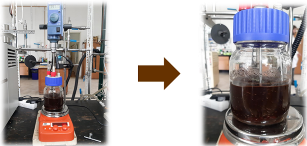
Slika 10. In situ transesterifikacija u magnetskoj miješalici primjenom CaO kao katalizatora
