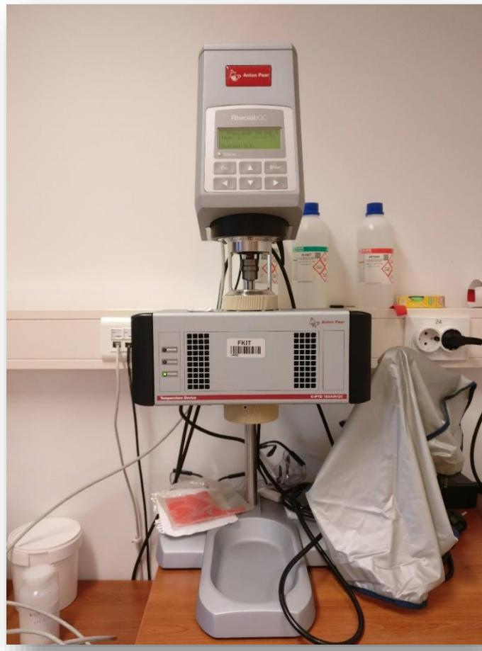
**Slika 3.4.** Rotacijski reometar RheolabQC
