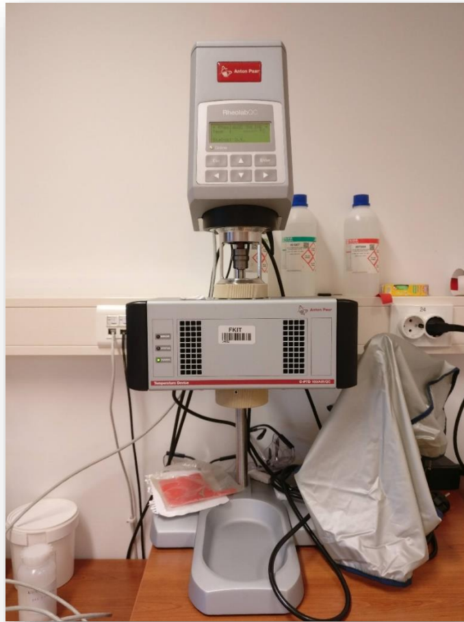
Slika 3.4. Rotacijski reometar RheolabQC (Anton Paar GmbH, Graz, Austrija)
