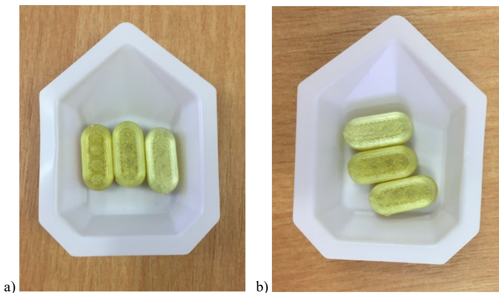
Slika 4. 3D-tiskane tablete: ispuna a) 25 % i b) 100 %
